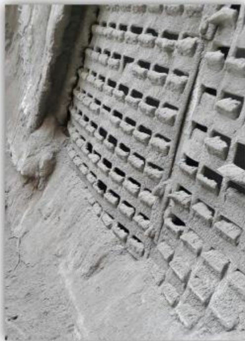
تصویر 31. توری ورودی الکتروفیلتر قبل و بعد از نظافت
