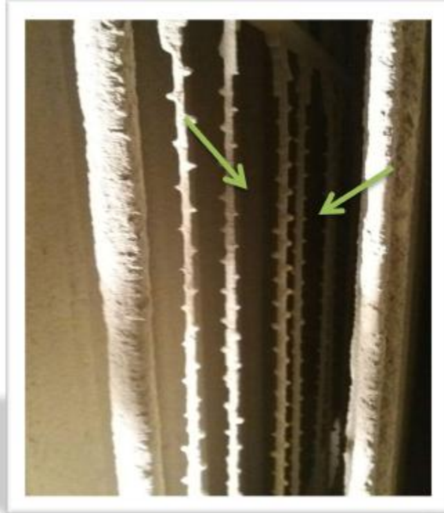
تصویر 4. کمبود الکترودهای دیسشارژ روی شاسی
