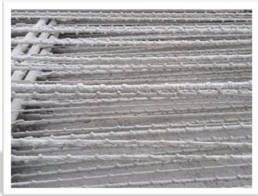
تصویر 6. کُت‌گرفتگی روی الکترودهای دیسشارژ
