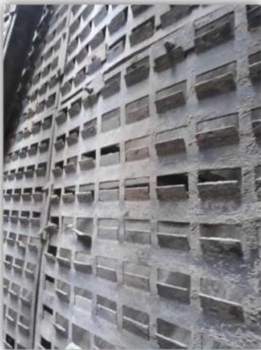
تصویر 31. توری ورودی الکتروفیلتر قبل و بعد از نظافت
