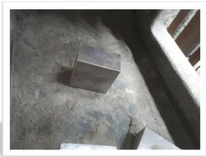
تصویر 11. سندانی برش خورده و سنگ خورده توسط واحد تراشکاری
