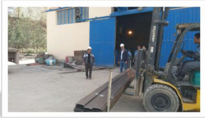
تصویر 9. جابجایی و انتقال صفحات جذب توسط لیفتراک
