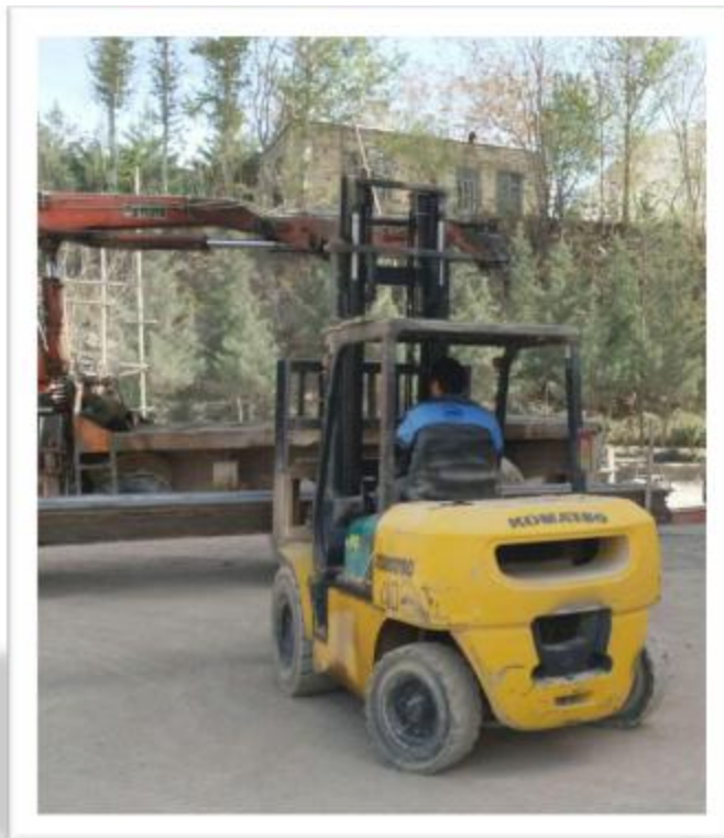
تصویر 8. بارگیری پالت صفحات جذب بر روی جرثقیل توسط لیفتراک
