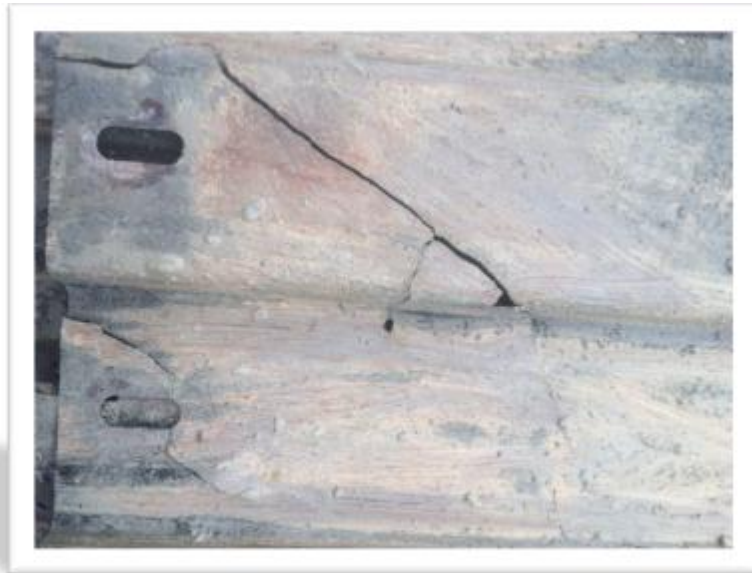
تصویر 3. شکستگی صفحات جذب از محل اتصال به تسمه‌های ریپینگ‌بار
