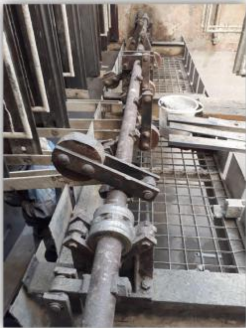
تصویر 30. سیستم ضربه‌زن قبل و پس از نظافت
