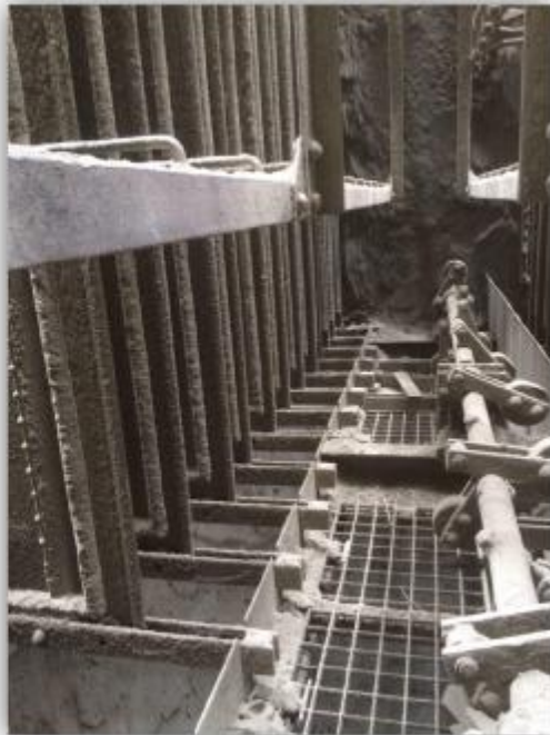
تصویر 30. سیستم ضربه‌زن قبل و پس از نظافت
